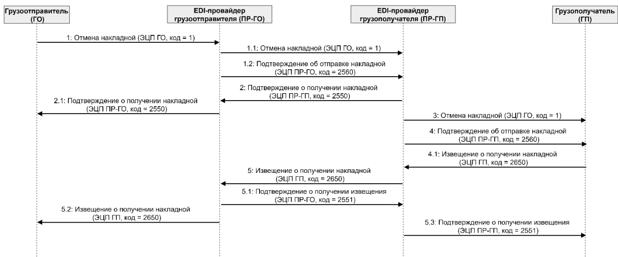
Рисунок 3.12 - Диаграмма последовательности отмены накладной грузоотправителем (два EDI-провайдера)
