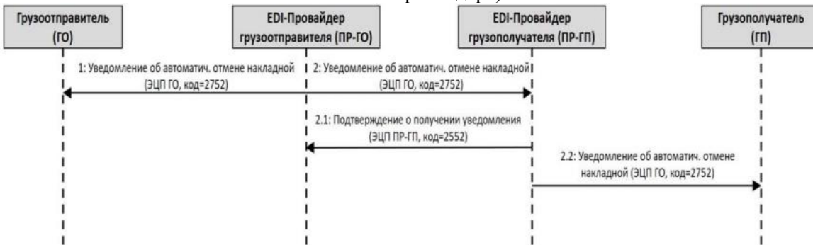
3.13 - Диаграмма последовательности автоматической отмены накладной EDI-провайдером грузоотправителя (два EDI-провайдера)
